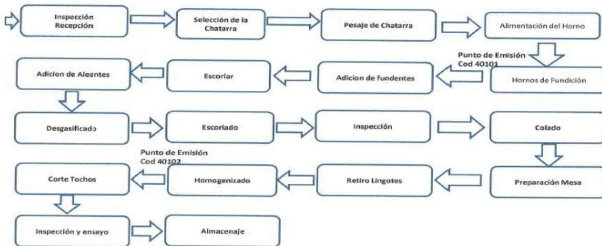
Diagrama Código 40000. Diagrama de Flujo FUNDICIÓN
