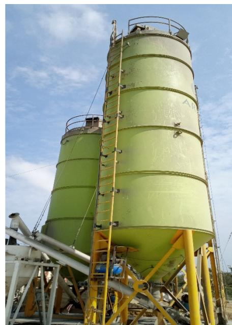
Foto 2. Silos de almacenamiento de cemento.
