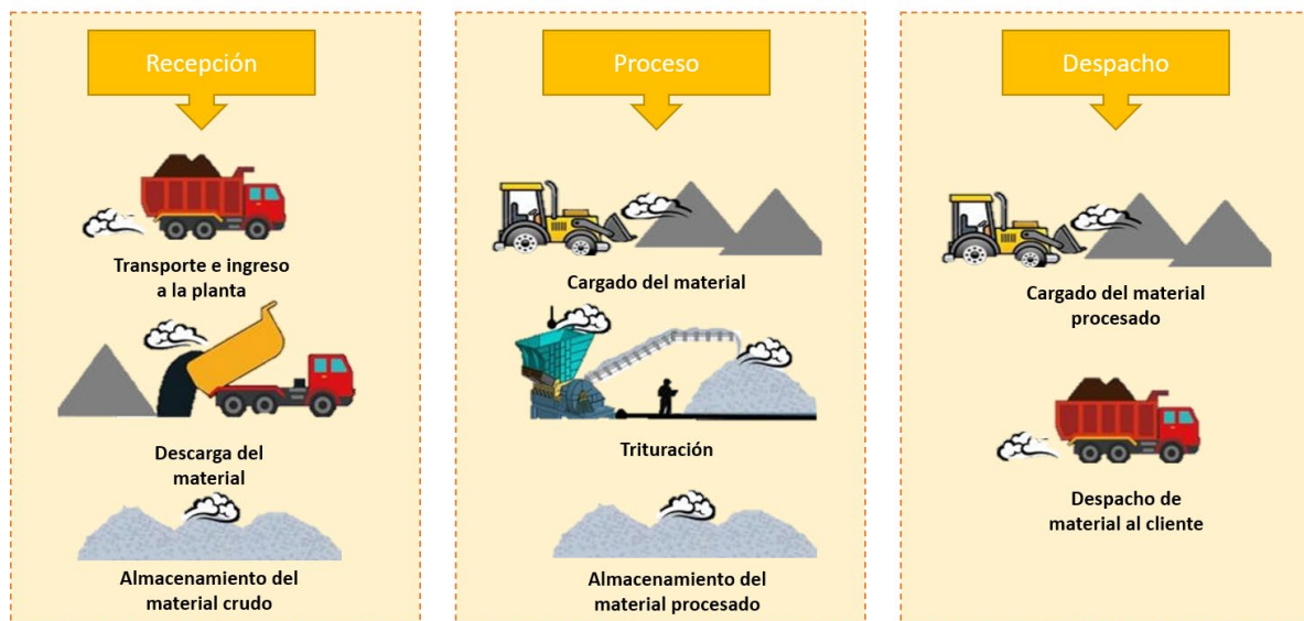
Imagen No. 2 – Proceso de trituración de material agregado- CARBONATO DE CALCIO Y ARENA ROCA GÓMEZ S.A.S.
