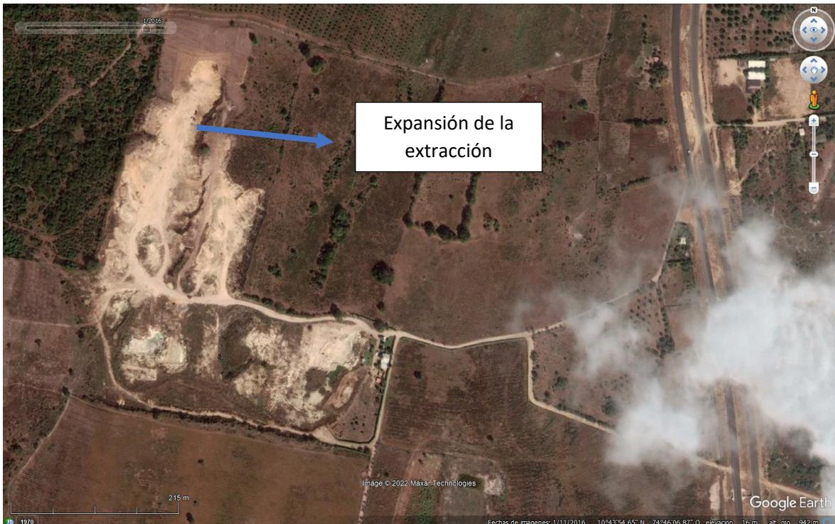
Figura 6. Imagen satelital de la cantera en el año 2020, con inicio de extracción hacia la zona de ruptura de talud.
