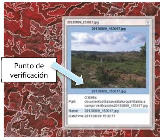
Figura 3-8. Identificación manual de coberturas por unidad de segmentación.
