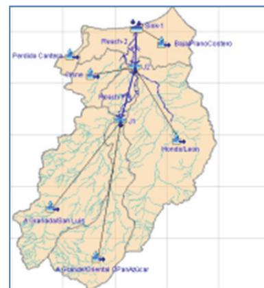
**Figura 3-30. Modelo lluvia- escorrentía en HEC-HMS.**
