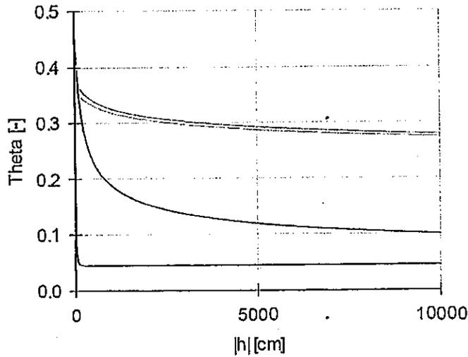
Figura 6. Propiedades hidráulicas ( $\theta$  vs  $\log h$ ).
