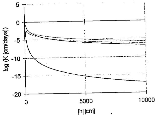
La gráfica anterior evidencia que la conductividad hidráulica en las primeras capas del suelo, es alta debido a la presencia de arenas y limos, y el tránsito del flujo se hace rápidamente, pero a medida que se atraviesa la ZNS, la conductividad baja, debido a la presencia de materiales arcillosos y por ende, el tiempo de transporte es mucho más lento.
