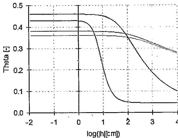
Respecto a las propiedades hidráulicas, se puede determinar que el contenido de agua reteniendo en el suelo, disminuye en las primeras capas (arena y arena limosa), debido a la alta permeabilidad de la misma; la curva de retención disminuye rápidamente, a medida que el agua fluye a través de la ZNS, que persiste hasta 4,5 metros, donde se encuentra el material arcilloso.
