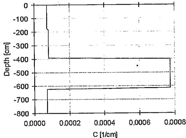
En la figura anterior, se observa que en los primeros 4,5 m el suelo comienza un proceso rápido de infiltración, donde se encuentran las arenas y arenas limosas, materiales con una gran permeabilidad, pero luego de esta profundidad y hasta alcanzar el punto de análisis, continua con la infiltración de una manera moderada, pues la textura del suelo es un poco arcillosa.
