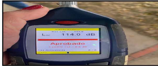
Foto No.5 Calibración de los equipos.
