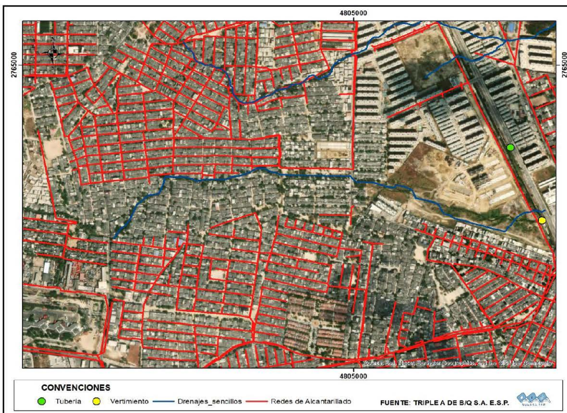
FIGURA 1. BARRIOS NO CONECTADOS AL SISTEMA DE ALCANTARILLADO DE TRIPLE A.
