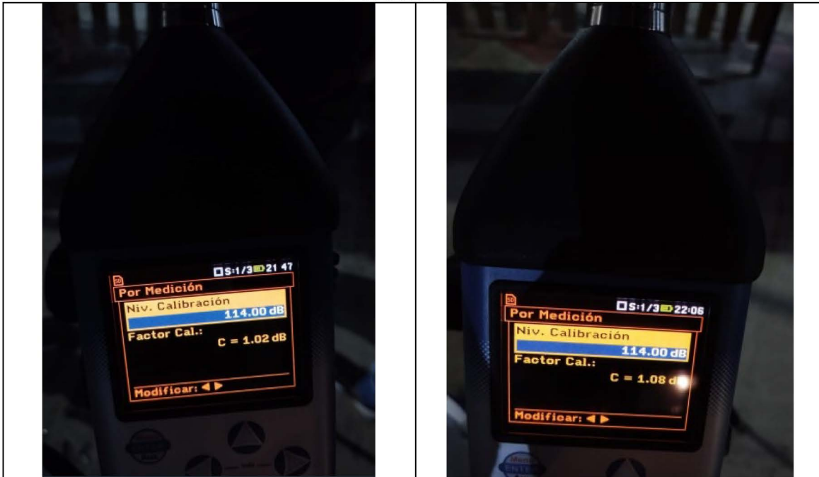
Calibración de sonómetro para medición con fuente apagada.
