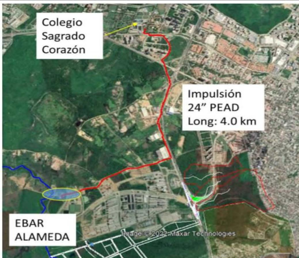
*Figura 11 Trazado de Impulsión de 24” PEAD*
