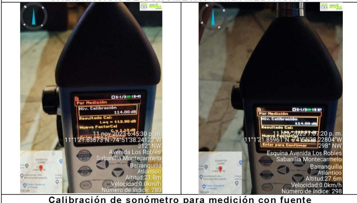
Calibración de sonómetro para medición con fuente
