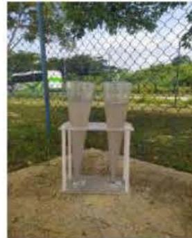
**Fotografía 7.** Medición de Sólidos sedimentables -Salida
